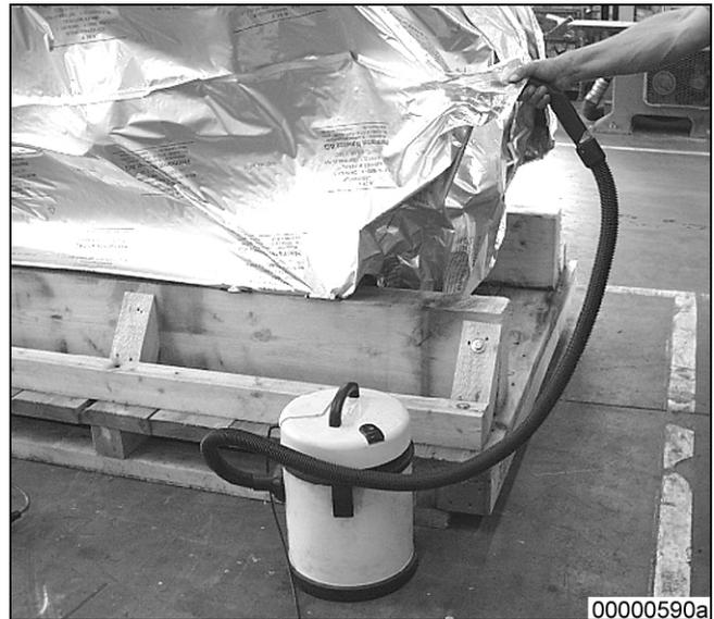
Die Hülle muss sich durch den entstehenden Unterdruck leicht an den Motor anlegen. Ein zu enges Anliegen der Hülle muss vermieden werden, da durch die Transportbeanspruchung die Hülle durchscheuern kann.
