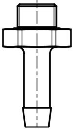
Schlauchstutzen mit O-Ring
